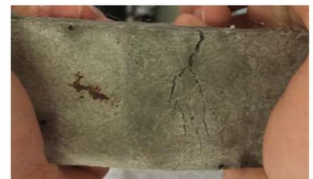
图1 ECC弯曲时多裂缝开裂现象(b)
