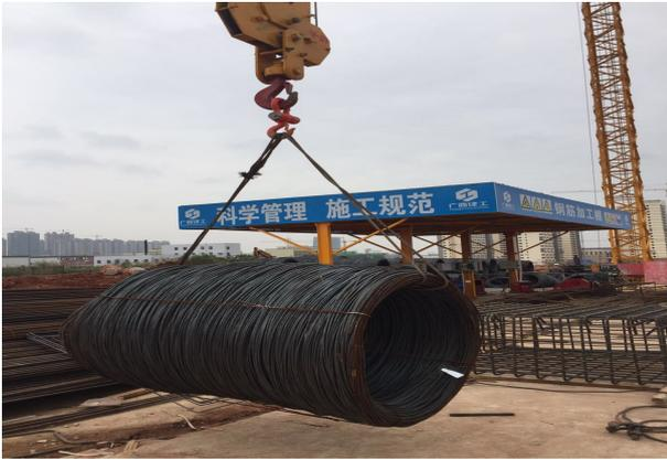
图2 现场定码定幅测试
