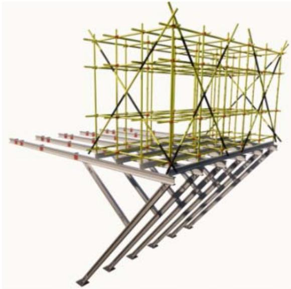
图1 大跨度空间悬挑结构BIM建模分析
