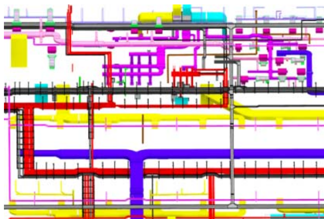
图1 Revit三位模型进行管线综合布置
