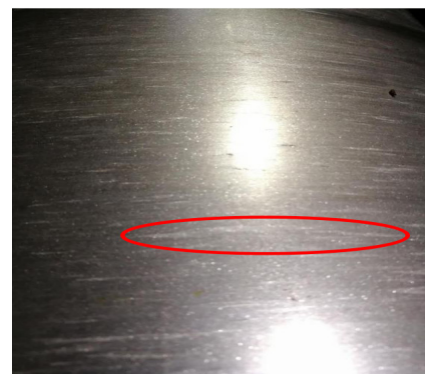
图5 压辊表面的凹坑
