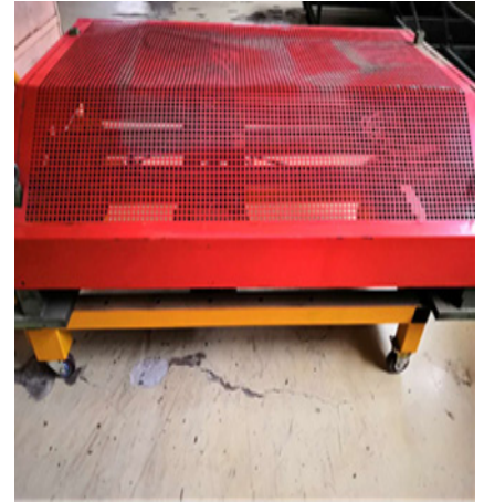
图6 压梗机压辊自动磨削装置
