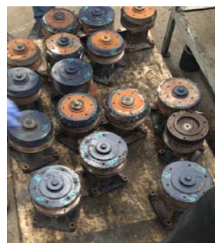
(a) 风扇托架损坏
