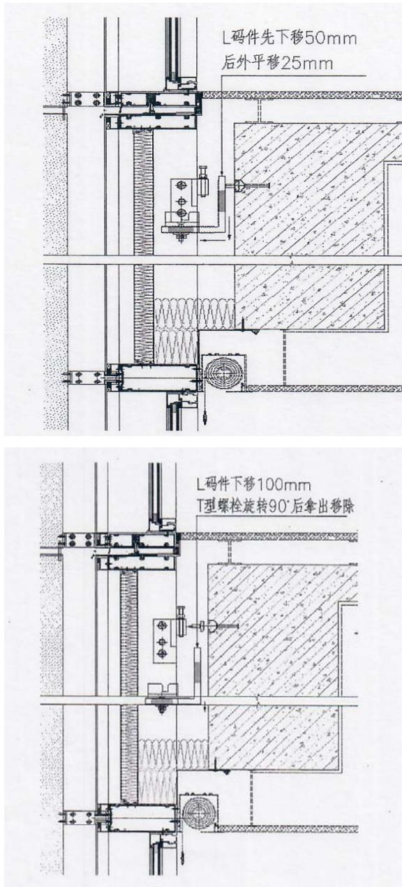
(4)在T型螺栓进行更换时，将L码件适当倾斜角度后，将新的T型螺栓斜插就位，将已经更换后的T型螺栓跟L码调整垂直，将T型螺栓跟L码垂直上移，当T型螺栓跟L码移动到预埋槽式埋件时，将T型螺栓旋转90°入槽，当T型螺栓入槽后将垫片及螺母装上拧紧，即T型螺栓更换完成，见下图。
