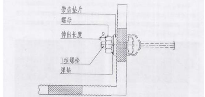
(2)本工程设计要求预埋件T型螺栓在铝合金L角码固定后,螺母需配置弹垫片,避免螺母在后期使用过程中松动退出;
