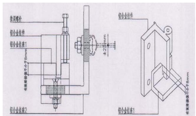
3.1.2 个别部位预埋件T型螺栓长度不足及弹垫片缺失的情况。由于预埋件T型螺栓长度不足及弹垫片缺失的情况可能会产生结构安全隐患,为保证本项目的安全质量。
