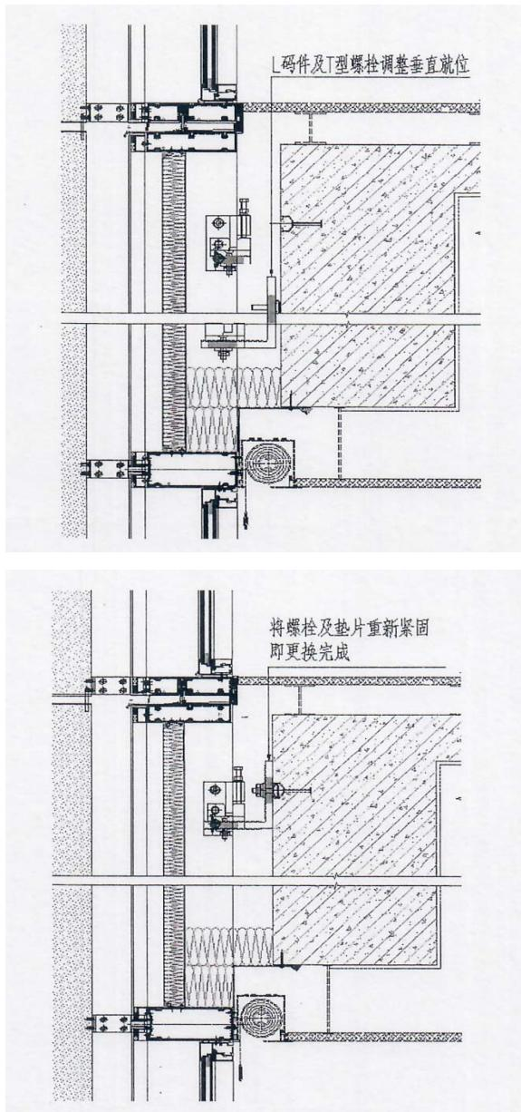
在检测过程中发现局部L型铝码与结构梁之间存在空隙，根据现场实际情况采用以下两种处理方案。
