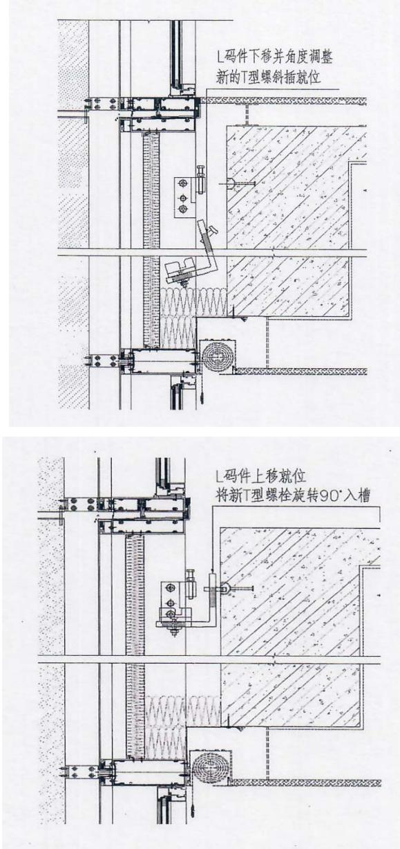
(5)类似的位置按同样的方法实施；为了保证T型螺栓安装进入槽内后确保拧到90°，即T型螺栓与槽成90°角状态，要在T型螺栓的侧边用油性红色大头笔在T型螺栓侧面画一道红线，红线在T型螺栓拧90°后一定要朝上，从此判断T型螺栓是否拧90°到位。
