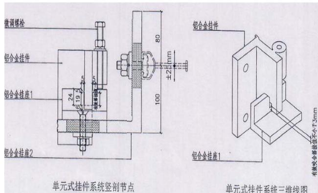
(2)为保证单元板块有效传递自重及控制板块左右位移,“铝合金挂件”与“铝合金挂座1”设计有互相咬合机构,安装稳定状态下有效咬合搭接值不应小于3mm。
